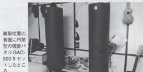
氏の設定した吸音→吸音→反射の状態に市販の吸音パネルGAC-600をセットしたところ
